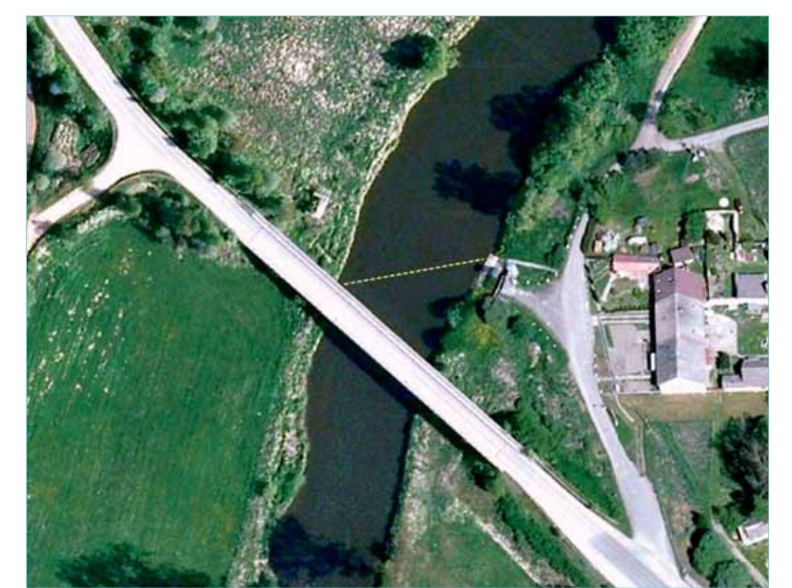
Zahájení provozu automatického jezu a malé vodní elektrárny na Lužnici u Klenovic v roce 2011 vyřadilo z provozu vodoměrnou stanici v Klenovicích. I tady byl instalován ultrazvukový průtokoměr, v tomto případě s jedním paprskem a dvojicí snímačů.
