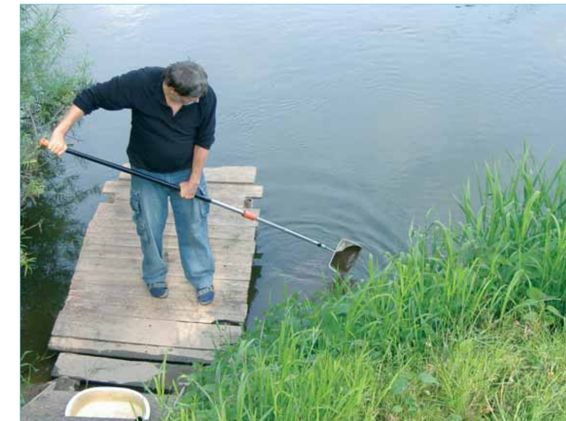
Odběr vzorku sedimentu hrabákem.
