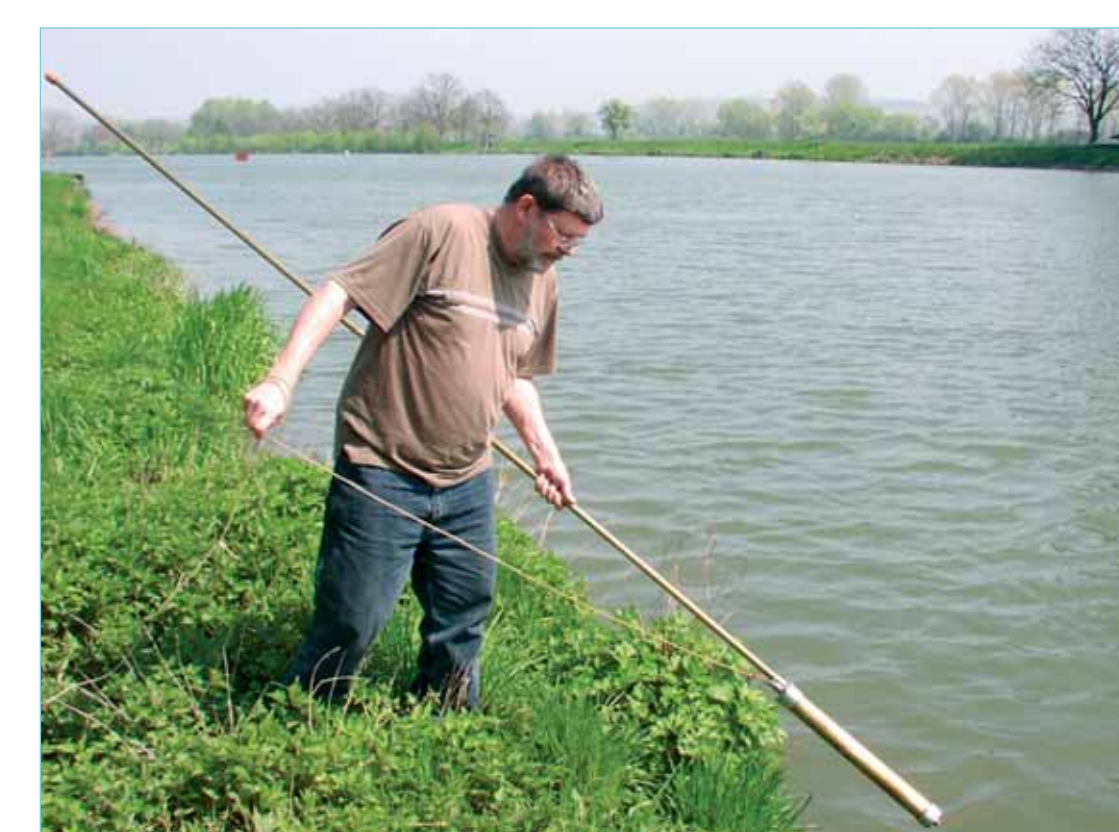
Odběr vzorku sedimentu píستem.
