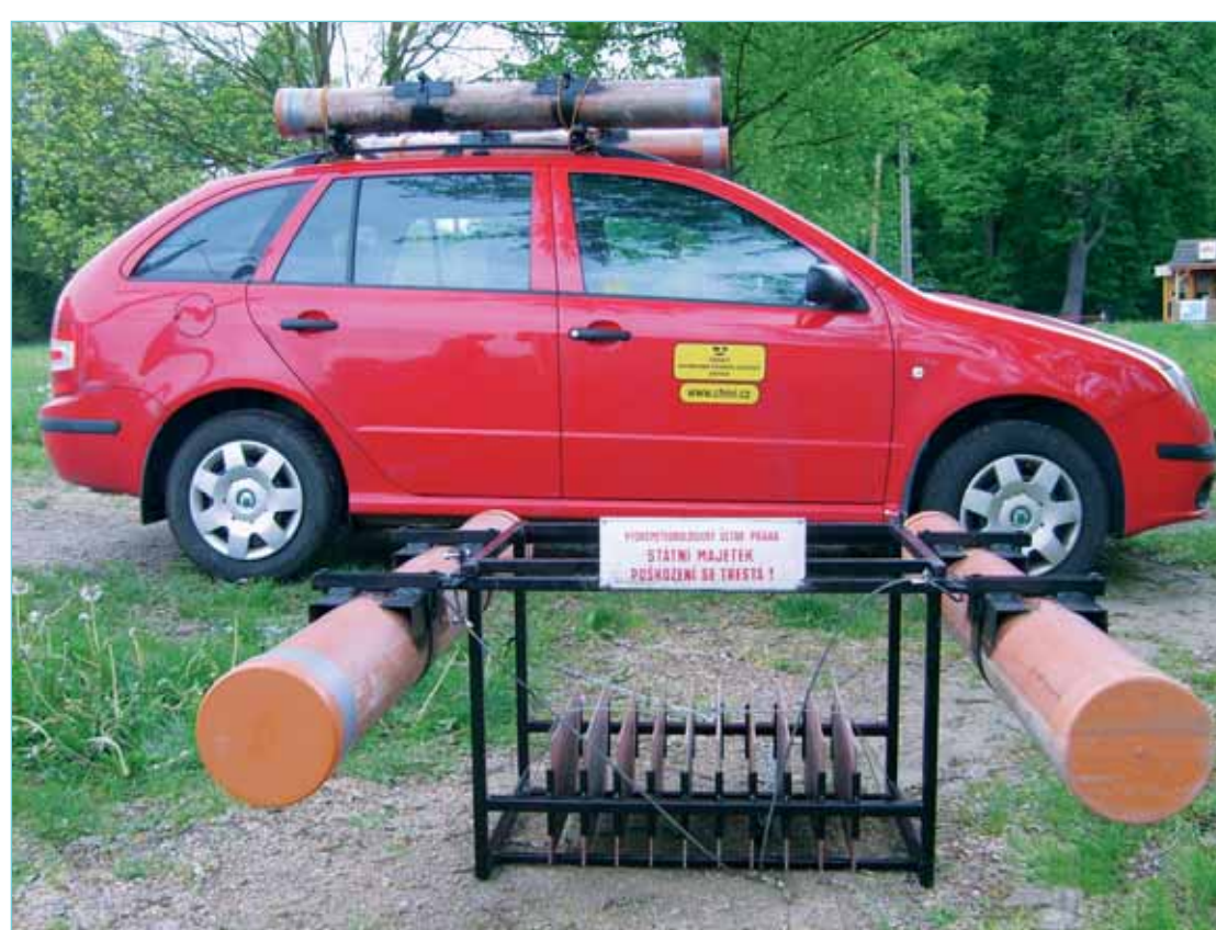
Plovák před instalací do toku.
